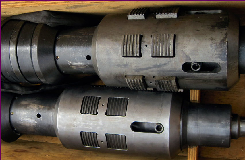
Retrievable Bridge Plugs zur Trennung der Bohrung von der gasgefüllten Kaverne
